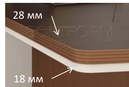
Составная столешница: ДСП 28 мм + МДФ 18 мм
