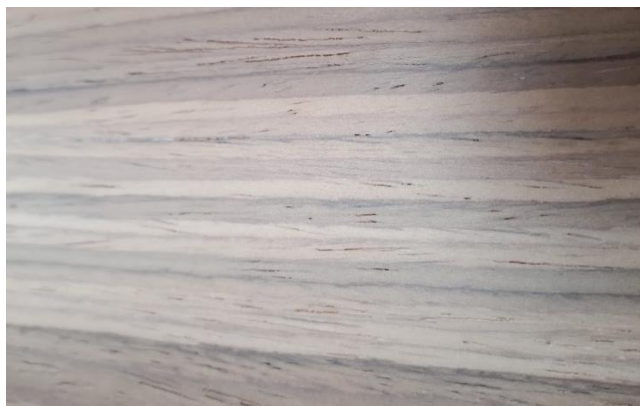
Фото «открытой поры» после отделки ЛКМ
